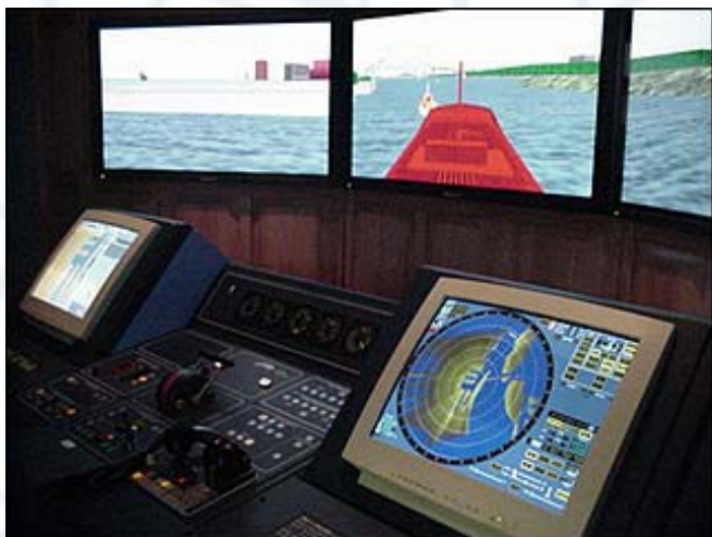
Simulateur de navigation dans le port de Montréal. L'écran du haut reproduit en trois dimensions la vision du commandant de bord. De gauche à droite, dans le bas de la photo : une carte électronique, les commandes du navire et l'écran radar.
